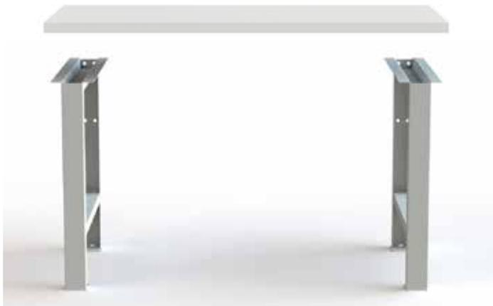
La pata de banco de trabajo de LISTA es una estructura estable de chapa de acero, de perfiles prensados soldados, con orificios para la fijación de la encimera. Es posible el anclaje al suelo mediante un orificio en la placa de suelo. Capacidad de carga de 400 kg. Anchura interior máxima de hasta 2220 mm, en función de la anchura de la encimera. Modelo: Chapa de acero. Color: según el catálogo de colores.
